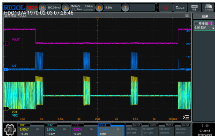
图 8: 输出短路过流、过温保护, 短路解除自恢复波形
