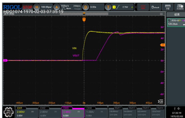
图 4: VIN=5V 空载启机波形
