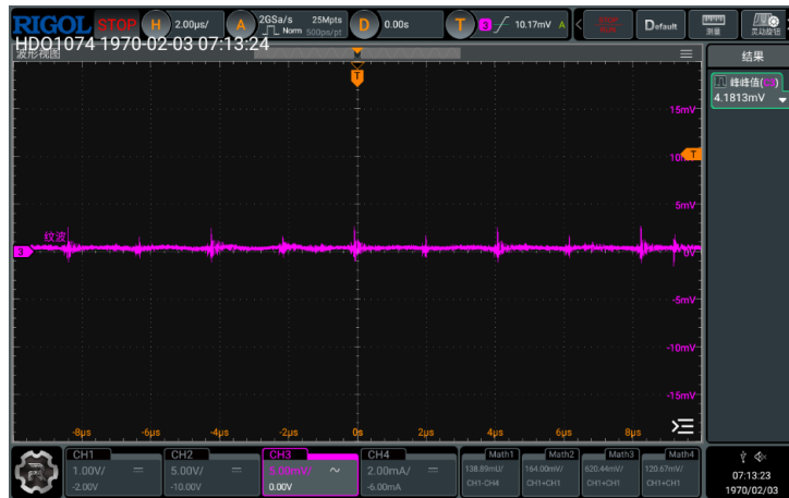
图 6: VIN=5V 空载纹波波形
