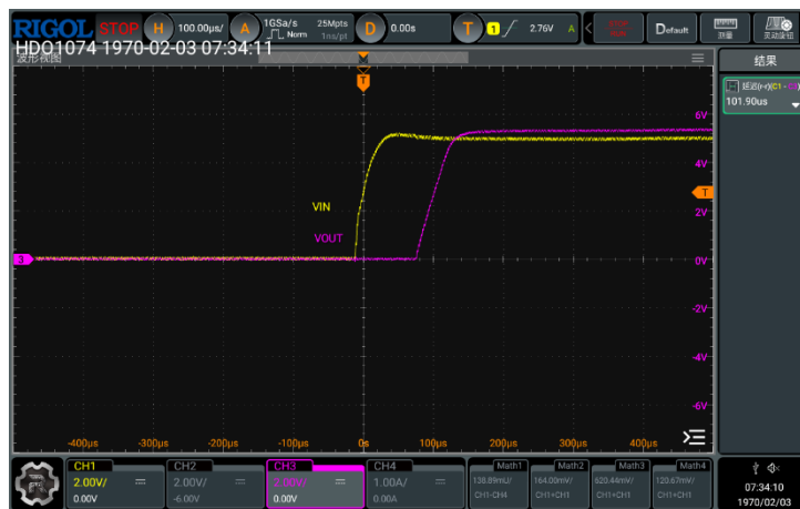
图 4: VIN=5V 空载启机波形
