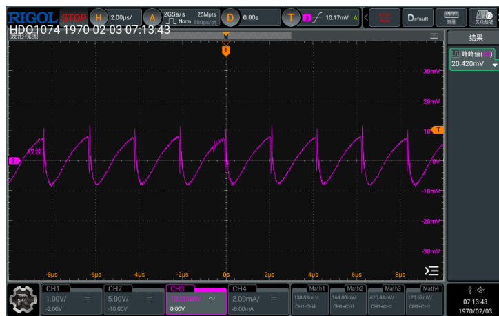
图 7: VIN=5V 满载纹波波形
